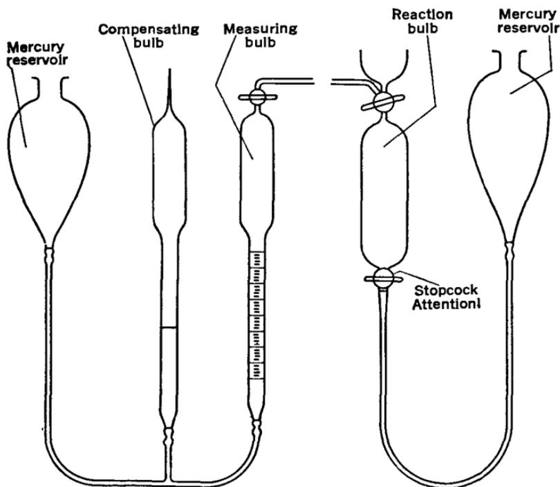
FIGURE 68. Du Pont Nitrometer.
